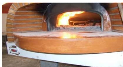
Questo bruciatore può essere montato su forni nuovi o già esistenti. La centralina elettronica regola automaticamente la temperatura voluta modulando la potenza del bruciatore. La combustione risulta pulita, riducendo fumo e residui. Il consumo di combustibile dipende dalla grandezza del forno, per uno di medie dimensioni occorrono circa 2 kg ora consumo elettrico 200 watt, alimentazione monofase 220 v.
